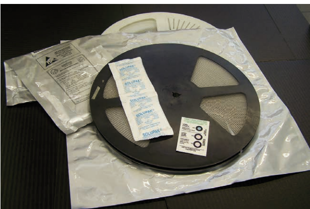
Bauteil-Rollen mit Feuchtigkeitsschutzbeutel, Feuchteschutzmittel und Feuchteindikator
