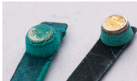
Beispiel für Korrosion an einem elektrischen Kontakt
