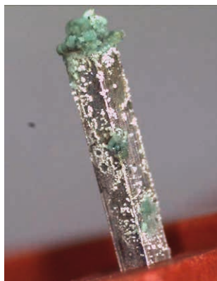
Beispiel für Korrosion an einem Bauteilanschluss (Pin)
